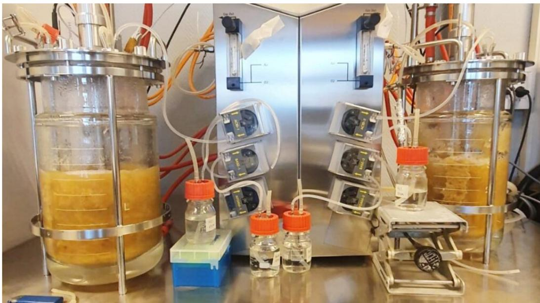
Reactores para a obtención enzimática de xilooligosacáridos a partir de palla de trigo.
